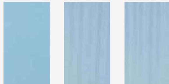
一般低汚染フッ素塗料と比較して雨筋汚れがつきにくく、塗替え後の美しさを保持することが確認されました。
