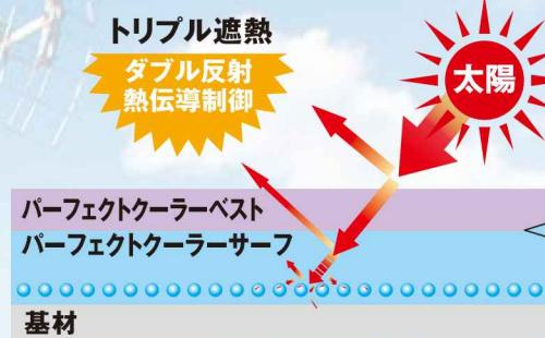
遮熱顔料と赤外線反射顔料により赤外線領域の波長を効率よく反射、さらに中空バブルが熱の伝わりを低減
