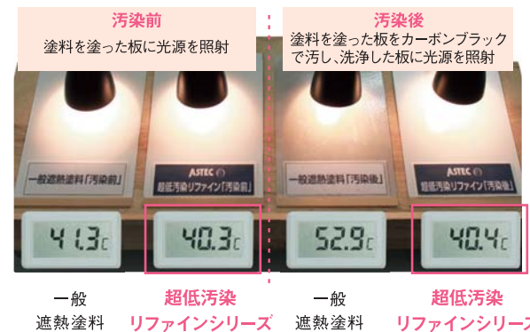
■防汚材料評価促進試験（I）結果
